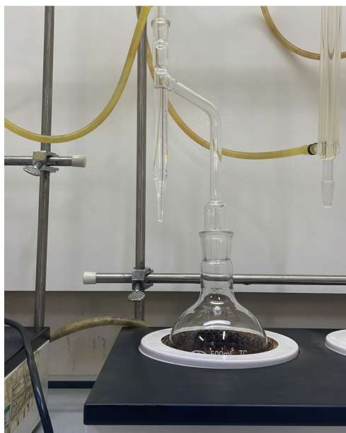
17-сурет – Мотор майларының су құрамын анықтау әдісі
