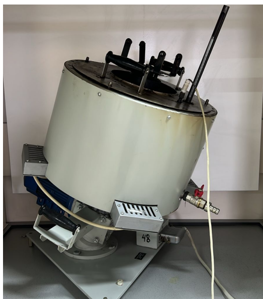
21-сурет – Тотығуға төзімділік анықтау аппараты ДК-НАМИ-М1-48
